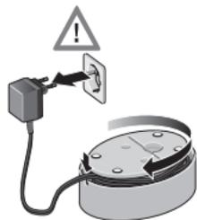
Se non si necessita della lunghezza completa del cavo, è possibile riporre parte del cavo di collegamento nel vano portacavo **9**.
