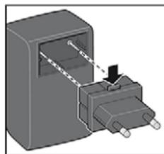
➤ Appuyez sur le bouton de dégagement dans le sens de la flèche tout en débranchant l'adaptateur secteur **10** monté.
