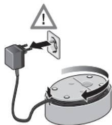
Si no necesita toda la longitud del cable, se puede guardar una parte del cable de conexión en el depósito de cable **9**.
