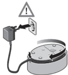
Если нет необходимости использовать провод на всю длину, можно разместить часть соединительного провода в месте для хранения кабеля 9
