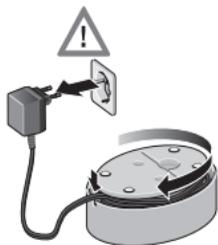
Wanneer u niet de volle lengte van de kabel nodig hebt, kan een deel van de verbindingskabel in de kabelopslag **9** worden opgeborgen.
