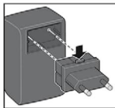
➤ Druk de ontgrendelingsknop in, in de richting van de pijl terwijl u de netstekker-adapter **10** loskoppelt.
