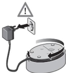
Wenn Sie nicht die volle Länge der Leitung benötigen, kann ein Teil der Verbindungsleitung im Kabeldepot **9** verstaut werden.
